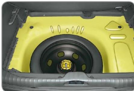
Запасное колесо находится под полом багажного отсека.
