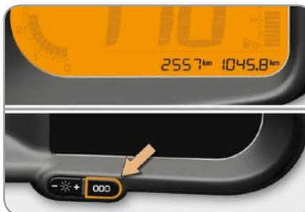
Общий пробег и расстояние, пройденное за поездку, показываются на дисплее в течение 30 секунд при выключении зажигания, при открывании двери водителя, а также при защирании и отпирании автомобиля.
