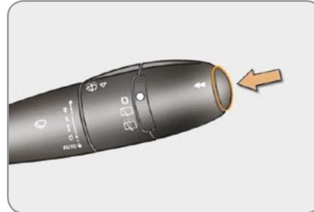
☞ Нажмите на кнопку, расположенную на торце **выключателя стеклоочистителя**, чтобы последовательно вывести на дисплей компьютера различные закладки:
