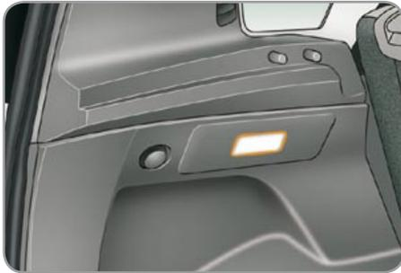
Он загорается автоматически при открывании и гаснет также автоматически при закрытии дверцы задка.
