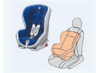
Для перевозки ребенка "лицом вперед". Оборудовано верхней лямкой, прикрепляемой к верхней проушине **В**, называемой TOP TETHER. Устанавливается для перевозки в трех положениях: сидячем, полулежащем и лежащем.
