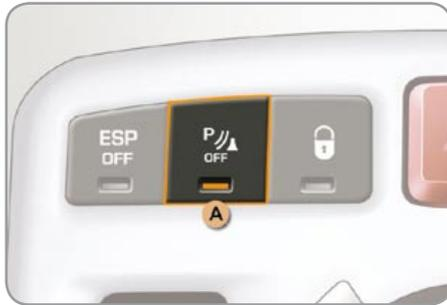
При работающем двигателе нажмите на кнопку **A**, чтобы окончательно выключить систему. При этом загорится вмонтированная в кнопку контрольная лампа.
