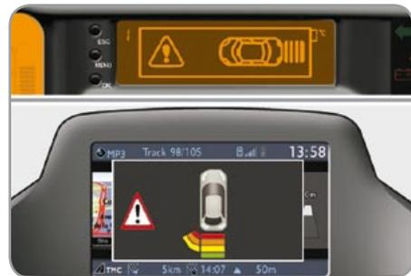
Если расстояние до препятствия становится менее 30 см, сигнал начинает звучать непрерывно, а на многофункциональном дисплее индицируется символ "Опасность".
