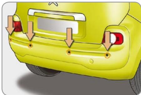
При приближении к какому-либо препятствию (напр., к человеку, автомобилю, дереву, изгороди, ...), расположенному сзади, датчики срабатывают и раздается звук зуммера. На препятствия, расположенные под бампером, датчики не реагируют.
