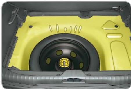
Запасное колесо находится под полом багажного отсека.
