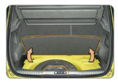
Буксировочное кольцо расположено под полом в багажном отсеке.
