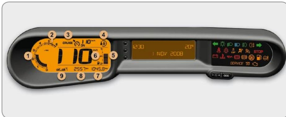
Панель, содержащая контрольный прибор, многофункциональный дисплей, индикаторы и сигнализаторы, отражающие работу бортовых систем.
