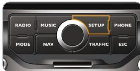
Нажмите на кнопку SETUP для получения доступа в меню "SETUP". Меню обеспечивает доступ к следующим функциям:
