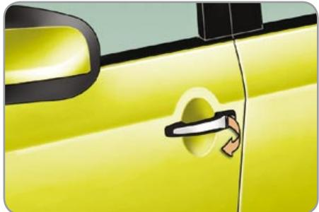
☞ Разблокируйте замки при помощи пульта дистанционного управления или ключа, после чего потяните за дверную ручку.
