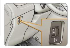
Чтобы не ослеплять других участников дорожного движения, необходимо отрегулировать угол наклона световых пучков фар с галогенными лампами в зависимости от загрузки автомобиля.
