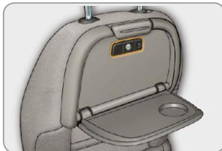
В спинках передних сидений за столиками устанавливаются индивидуальные светильники. При включенном зажигании они освещают поверхность столика, не создавая неудобств другим пассажирам. Светильники используются только при разложенном столике.
