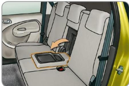
Разложенная полка, состоящая из двух частей, предоставляет дополнительные возможности по размещению различных предметов в дополнение к уже имеющимся в задней части салона ящикам для вещей.
