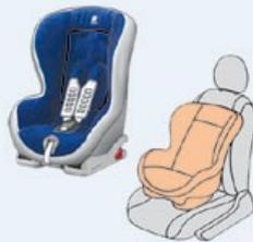
Для перевозки ребенка "лицом вперед". Оборудовано верхней лямкой, прикрепляемой к верхней проушине **В**, называемой TOP TETHER. Устанавливается для перевозки в трех положениях: сидячем, полулежащем и лежащем.
